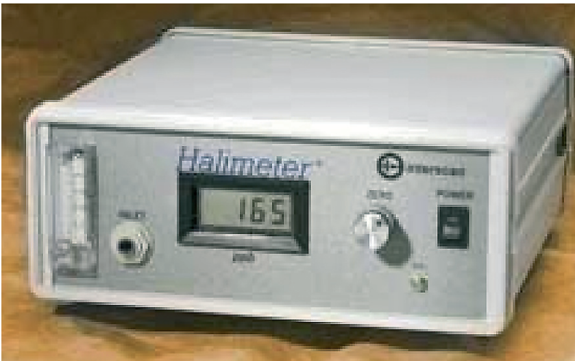
Figura 2. Monitor portátil de sulfuros.
